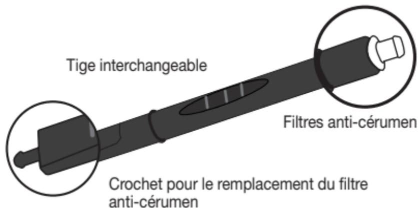
Les deux côtés de la tige interchangeable sont de forme différente. À une extrémité de la tige interchangeable se trouve un filtre anti-cérumen blanc. De l'autre côté, la tige est équipée d'un crochet qui permet de retirer facilement le filtre anti-cérumen usagé de l'amplificateur auditif.
