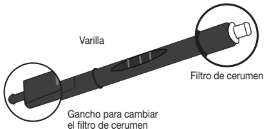
La varilla dispone de dos lados diferentes. En un extremo hay un filtro de cerumen blanco. En el lado opuesto hay un gancho para retirar fácilmente el filtro de cerumen usado del amplificador de sonido.
