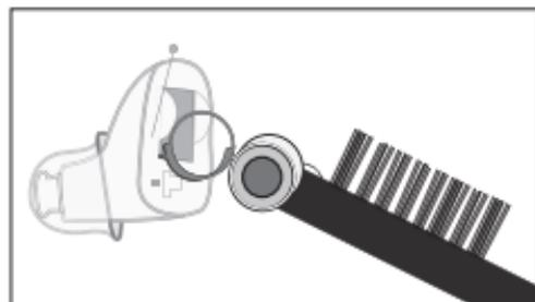
2. Coloque la pila de botón (tipo PR70/A10) incluida en los artículos suministrados en el compartimento como se muestra en el dibujo. Colóquela con la polaridad correcta (+/-). La pieza magnética del cepillo de limpieza le facilita este paso. El amplificador de sonido se enciende cerrando el compartimento de las pilas. Se apaga al abrirlo.
