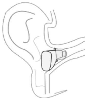
lentement. Assurez-vous que l'amplificateur auditif n'est pas inséré trop profondément dans le conduit auditif. Si l'embout auriculaire ne se place pas correctement ou s'il vous gêne, essayez un autre embout. Si même cela n'améliore pas de manière significative l'ajustement de l'amplificateur auditif, il est possible de le retourner latéralement.
