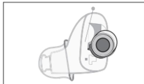
Ouvrez à nouveau le compartiment à piles pour éteindre l'appareil.
