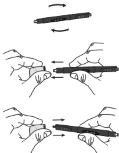
3. La tige interchangeable avec le filtre usagé peut être mise au rebut.
