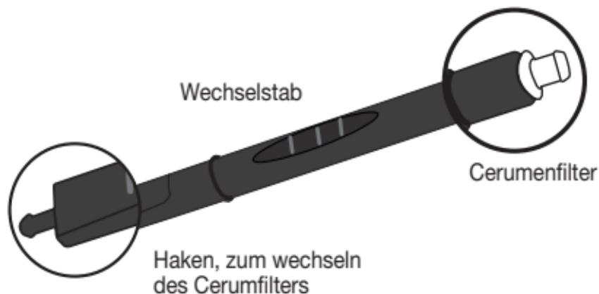
Der Wechselstab besitzt zwei unterschiedlich ausgeprägte Seiten. An einem Ende des Wechselstabs befindet sich ein weißer Cerumenfilter. Auf der gegenüberliegenden Stabseite befindet sich ein Haken, um den gebrauchten Cerumenfilter leicht von der Hörhilfe zu entfernen.
